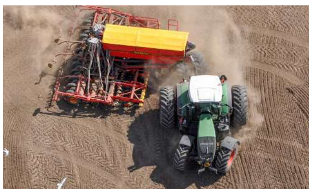
Впечатляюще малый радиус разворота, несмотря на внушительные габариты сеялки.
