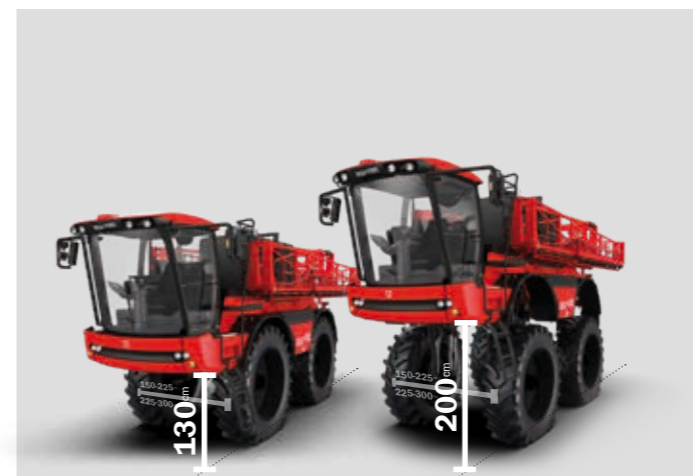
Гидравлический изменяемый клиренс от 130 до 200 см
