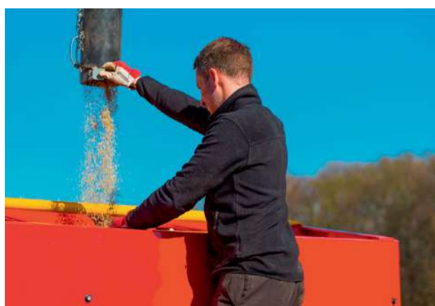
Скошенная передняя кромка бункера улучшает обзор механизатору. Широкое загрузочное отверстие и встроенная лесенка облегчают наполнение.
