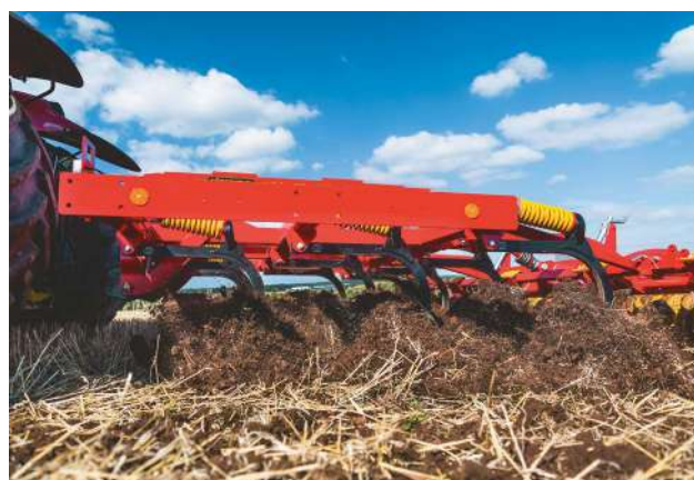
Высокопроизводительные стойки Cultus работают на глубине до 25 см.
