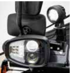
Комплект LED-фонарей дорожного освещения: • ходовые огни для движения по дорогам общего пользования • проблесковый маячок • фонарь заднего хода
