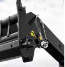
Отдельный вспомогательный контур гидрофицированного замка навесного оборудования
