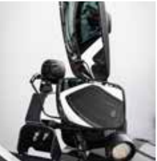
Дополнительные рабочие LED-фонари и зеркало с электрорегулировкой и подогревом
