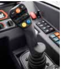
Smart-джойстик с управлением плавающим режимом стрелы и встряхиванием ковша
