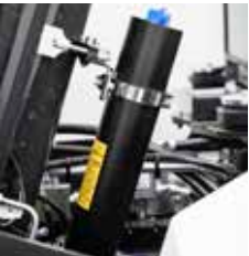
Система амортизации стрелы (азотный пневмогидроаккумулятор)
