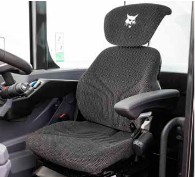
Сиденье Grammer Maximo с пневмоподвеской, подогревом, системой динамического демпфирования Dynamic Dumping System (DDS) и джойстиком на подпрессоренном подлокотнике
