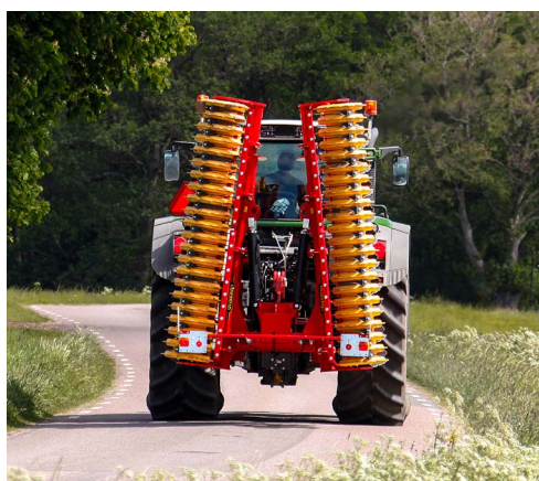
Транспортная ширина навесного Carrier XT всего 2.4 м.
