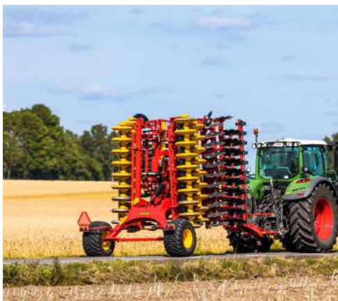
При транспортировке Carrier XL 425-725 между полями боковые секции машины складываются до транспортной ширины 3 м.
