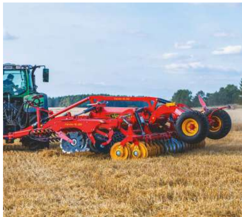
На разворотах машину можно поворачивать как на катке, так и на колесах.
