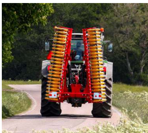
Транспортная ширина навесного Carrier XT всего 2.4 м.
